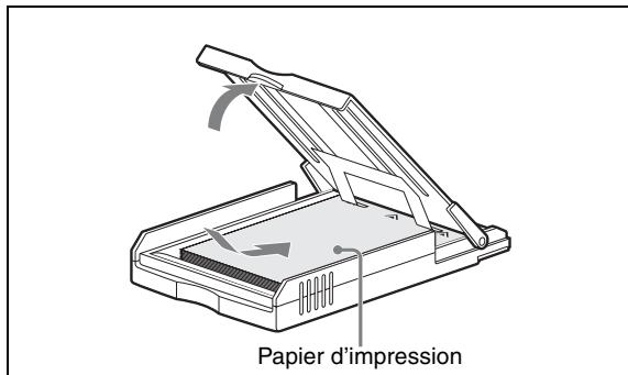
Eventez le papier avant de le charger avec la surface d'impression (côté sans marque) vers le haut. Vérifiez que la flèche sur la feuille protectrice pointe vers la même direction que celle sur le bac. Vous pouvez charger jusqu'à 25 feuilles en utilisant la série UPC-X46 et 30 feuilles avec la série UPC-X34.
